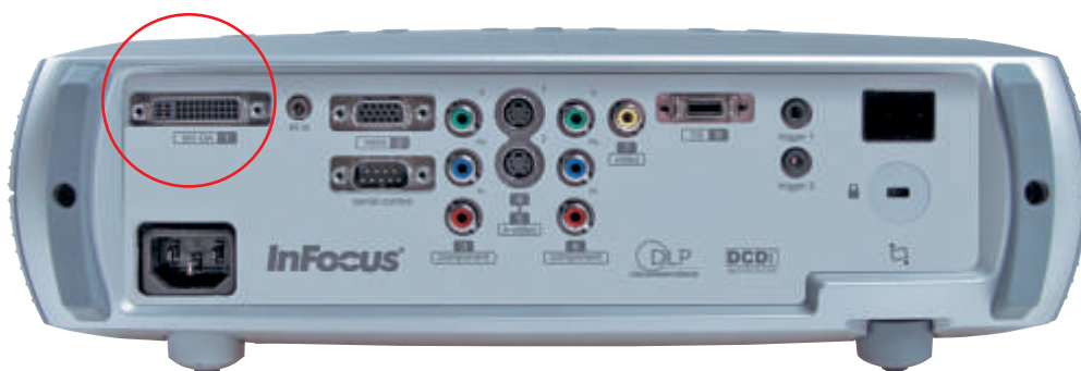
Il connettore EVC P&D di cui è dotato tanto l'SP5700, quanto l'SP7200 permettono una connessione DVI in digitale con la sorgente. Questo tipo di collegamento garantisce le massime prestazioni, eliminando, di fatto, tanto la conversione D/A nella sorgente, quanto quella A/D nel proiettore.
