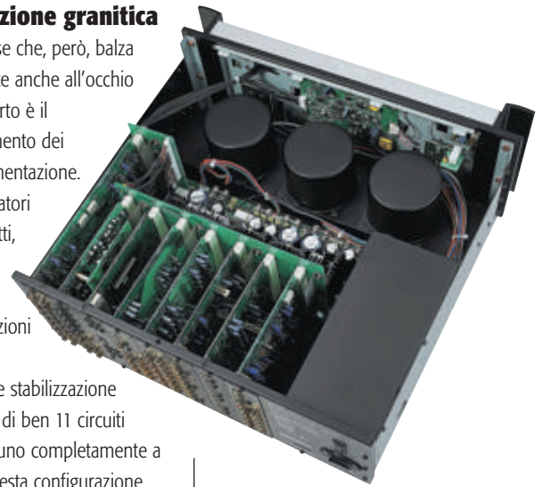
La costruzione è modulare; una architettura del genere permette la massima espansibilità ed aggiornabilità. La componentistica impiegata è eccellente, mentre curato è lo stadio di alimentazione che adotta ben 3 trasformatori toroidali, completamente separati.
