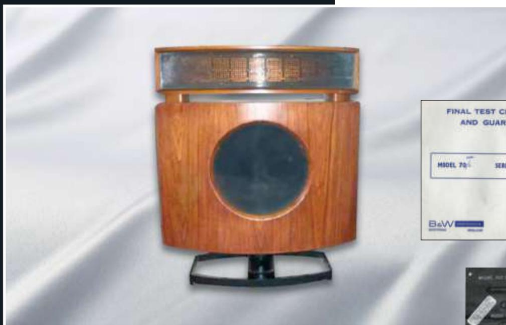
In effetti l'unità elettrostatica superiore era di forma lievemente circolare per aumentare l'angolo di emissione, ma il mobile sottostante ne seguiva i lineamenti, formando
