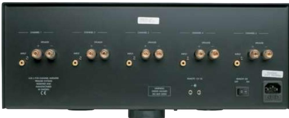
*Il finale A30.5mkII è un oggetto progettato con grande cura. 5 sezioni di alimentazione completamente separate, e circuitazioni finali completamente indipendenti e realizzate con elementi ad alta velocità. Molto robusti i morsetti di uscita, in grado di accettare ogni tipo di cavo.*
