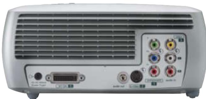
Il parco ingressi è davvero molto ricco, oltre all'SVideo e al videocomposito, infatti, sono presenti component, DVI in M1 e una uscita trigger per la discesa dello schermo. Un ingresso USB provvede al collegamento con un PC per aggiornamenti software.
