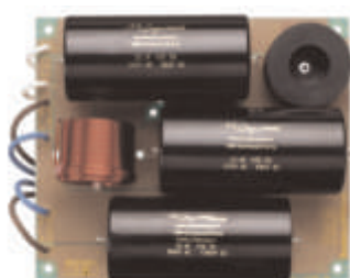
Le capacità di filtro Mundorf utilizzate sono costruite su specifiche B&W dal costruttore tedesco
