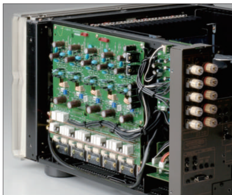
Una delle schede di amplificazione finale sistemata su un fianco dell'apparecchio. I dispositivi di potenza sono montati in fondo ed assicurati ad una grossa aletta di raffreddamento. Notare i morsetti per i diffusori di grandi dimensioni e in grado di serrare ogni tipo di terminazione.
