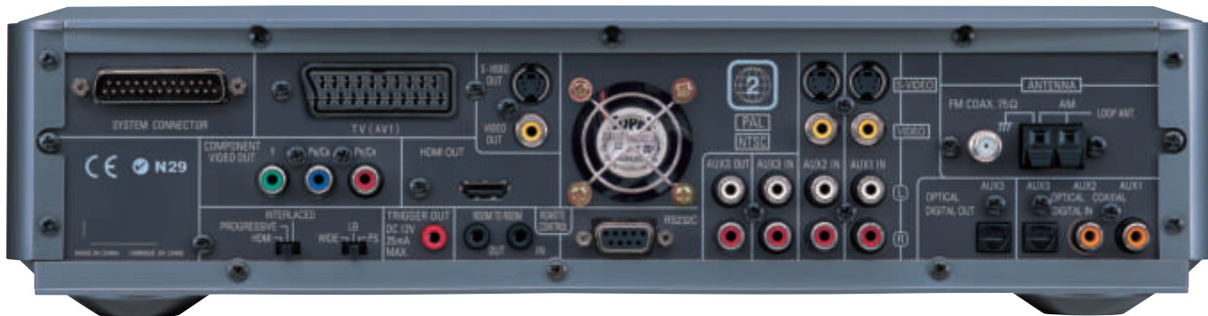
Le connessioni disponibili sono molteplici e in grado di venire incontro ad ogni esigenza. Notare l'HDMI, il component video e i numerosi ingressi audio sia analogici che digitali.
