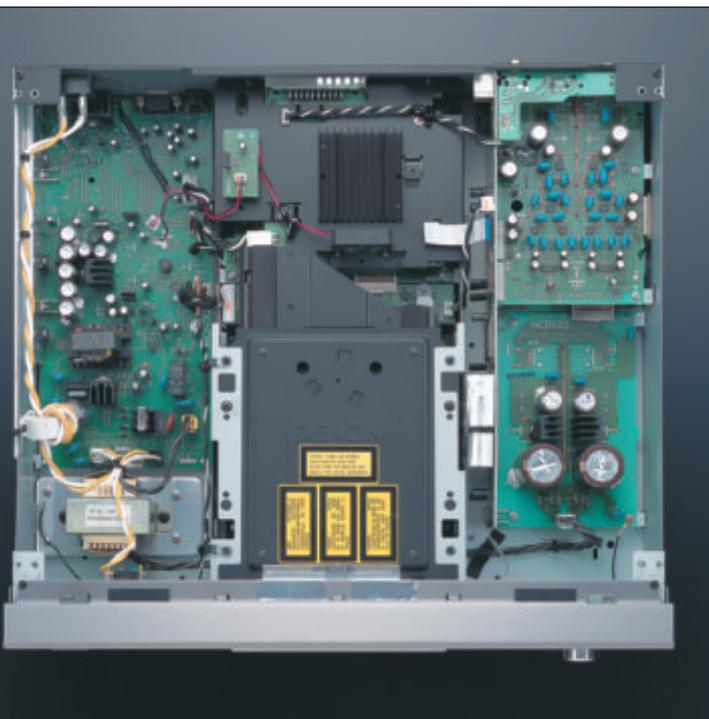
L'interno del DVD-3930 denota l'alto grado di ingegnerizzazione della macchina. Filatura ridottissima e utilizzo di componenti di livello assoluto. Notare a destra il doppio stadio di alimentazione trasformatore-switching.
