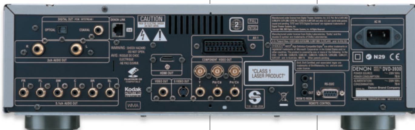
Numerose le uscite a disposizione. Dall'HDMI fino al doppio component, una BNC e una PIN RCA, e SCART ovviamente con RGB e SVideo/composito. Notare, a destra, l'eccellente qualità dei pin di uscita audio L e R, gli stessi utilizzati dai top di gamma.
