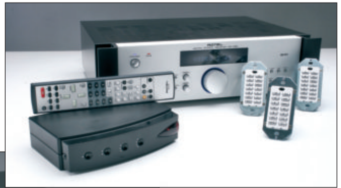
Il sintoamplificatore completo dell'Hub RHB200 e dei key-pad murali RKB-200, necessari per pilotare i 3 ambienti remoti. In basso il pannello posteriore dell'RHB200 con tutte le connessioni necessarie.
