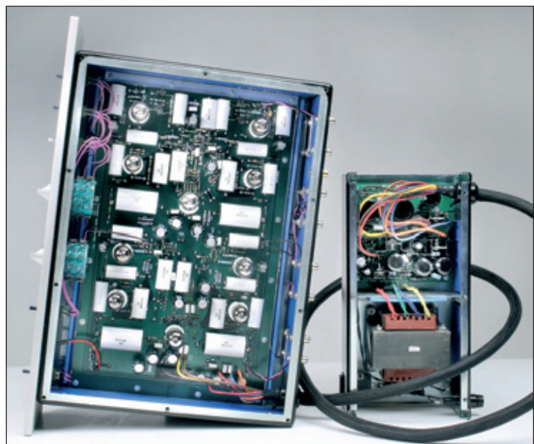
La costruzione dell'SL1 Ultimate MKII è esemplare e raccoglie 20 anni di esperienza sul progetto da parte di Ken Stevens deus-ex-machina di Convergent. Notare lo chassis irrobustito con materiale inerte per assorbire le vibrazioni provenienti dall'esterno.
