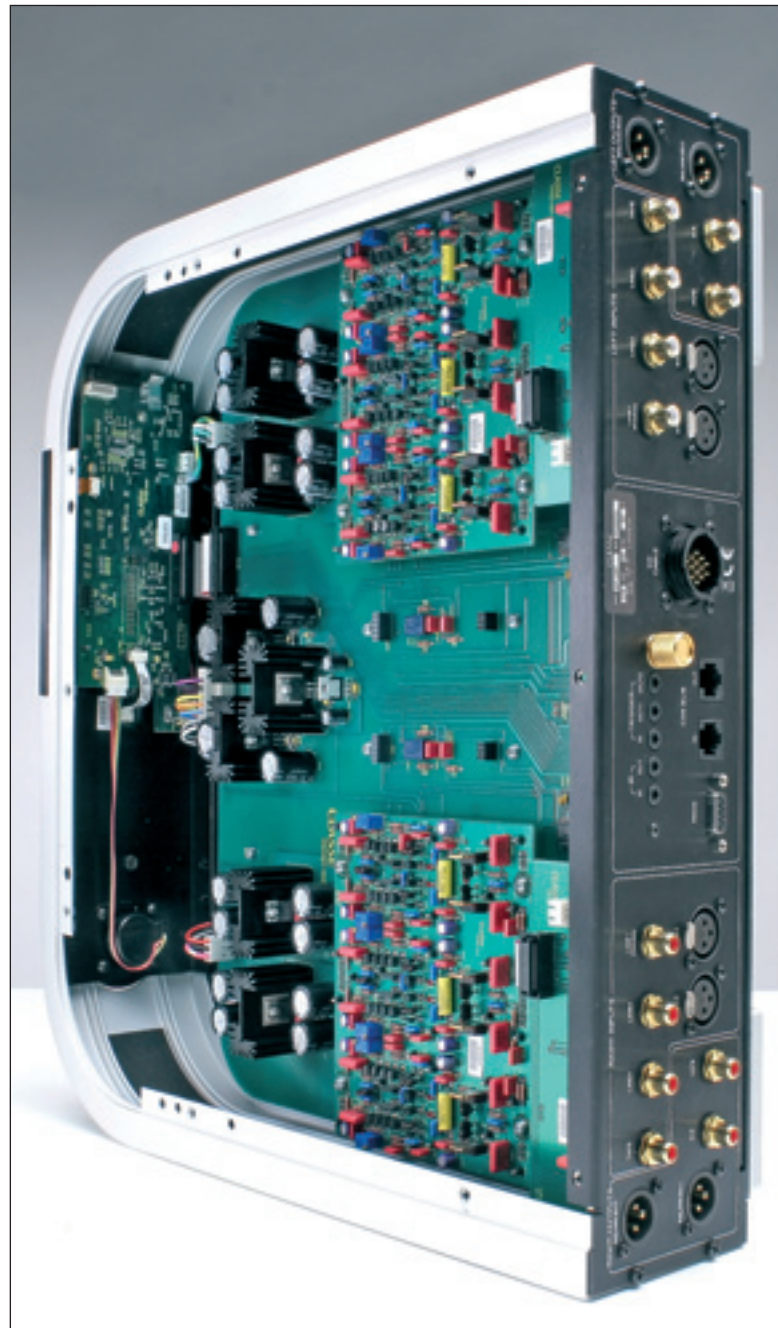
Il CP700 mostra una costruzione totalmente dual-mono, nella quale l'unico elemento in comune tra i due canali è il contenitore.
