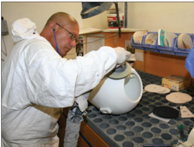
La levigazione di una delle teste Marlan semilavorate, che precede la verniciatura a forno fatta completamente a mano
