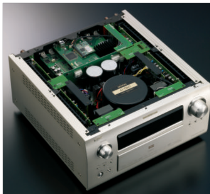
Numerose le sezioni di alimentazione. In evidenza il grosso trasformatore toroidale che alimenta le amplificazioni di potenza insieme con i 2 elettrolitici di livellamento. Nell'AVC-A1 HD sono presenti 7 diversi trasformatori dedicati ognuno a una particolare circuizione per evitare interferenze.
