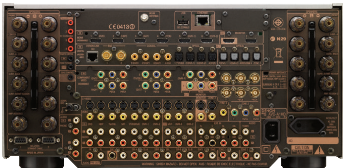
La connettività e la flessibilità sono impressionanti. Possibilità di connessione con rete ethernet, sia con cavo che wi-fi, numerosi in/out HDMI e un impressionante numero di ingressi e uscite audio sia digitali che analogici. Davvero non si potrebbe chiedere di più!
