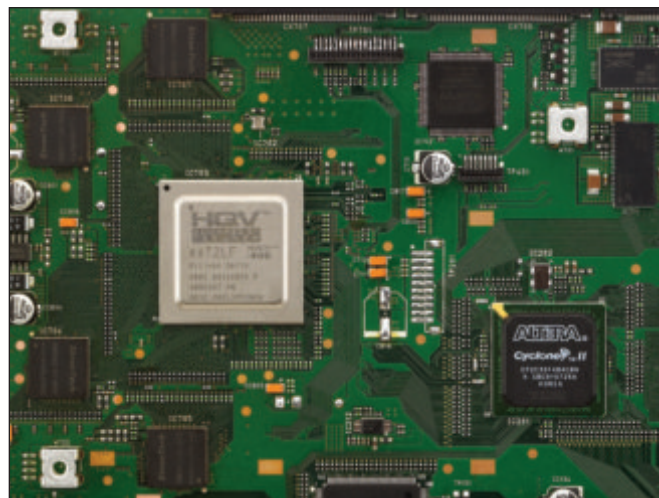
Il chip REALTA responsabile delle ottime prestazioni di scaling e deinterlaccio sul segnale video di cui l'AVC-A1HD è capace. Quest'ultimo può definirsi a tutti gli effetti una vera e propria centrale multimediale top di gamma.
