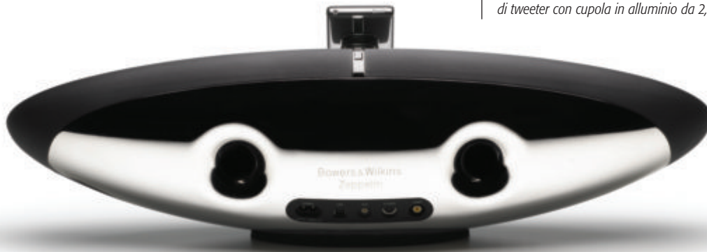
Lo Zeppelin è dotato di un subwoofer da 12,5 cm, di due medi da 9,5 e di una coppia di tweeter con cupola in alluminio da 2,5cm che prendono spunto dal progetto Nautilus
