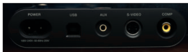
Un ingresso per sorgenti esterne, anche digitale ottico e uscita composito e SVideo per fruire anche dei contenuti video all'interno dell'iPod. La USB ha solo funzione di aggiornamento software
