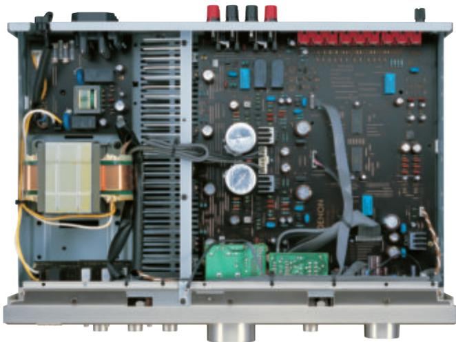
L'interno del PMA-700AE mostra una costruzione ben al di sopra della propria categoria di prezzo. L'interno dello chassis è suddiviso in due sezioni, da una parte la sezione di preamplificazione e controllo, a sinistra la sezione di alimentazione e potenza. Molto ben dimensionato il trasformatore di alimentazione, responsabile dell'ottimo comportamento dinamico dell'amplificatore.
