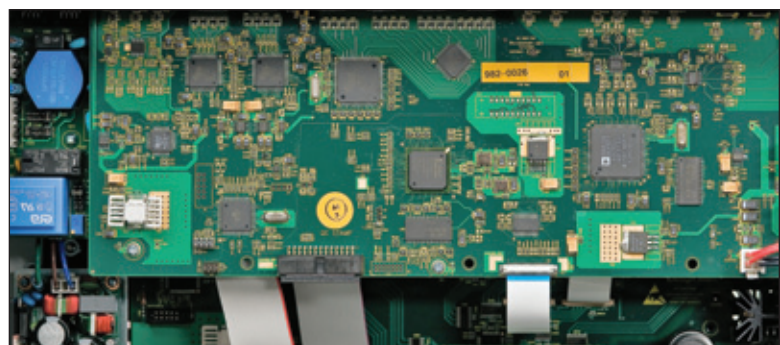
Particolare della circuitazione interna, dove è possibile accedere al DSP Texas Instruments per sostituirlo in caso di aggiornamento.
