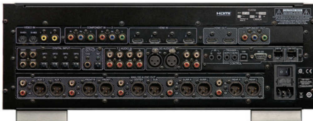
Il pannello posteriore dello SSP-800 è molto ordinato e razionale ad onta delle numerose opzioni esistenti. Fan spicco le connessioni XLR per il collegamento in bilanciato.
