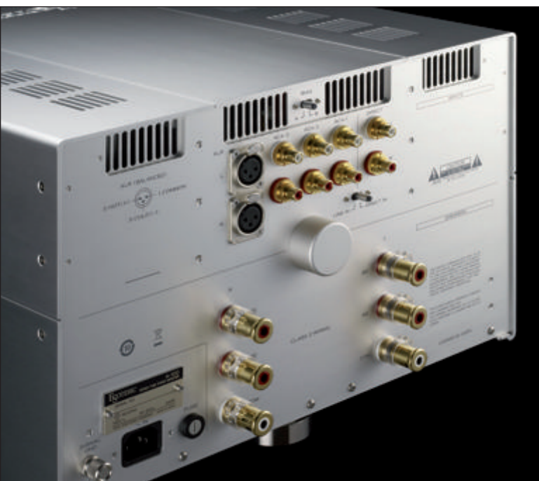
Il pannello posteriore dell'Esoteric A-10, oltre a mettere in mostra l'ottima qualità dei morsetti e dei connettori (RCA e XLR), presenta dei selettori per l'impiego come finale puro, in alternativa ad amplificatore integrato.
