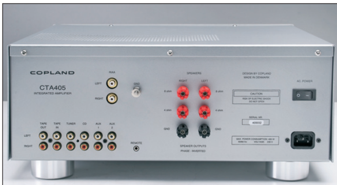
Il pannello posteriore è molto ordinato e denota la eccellente versatilità dell'amplificatore.
