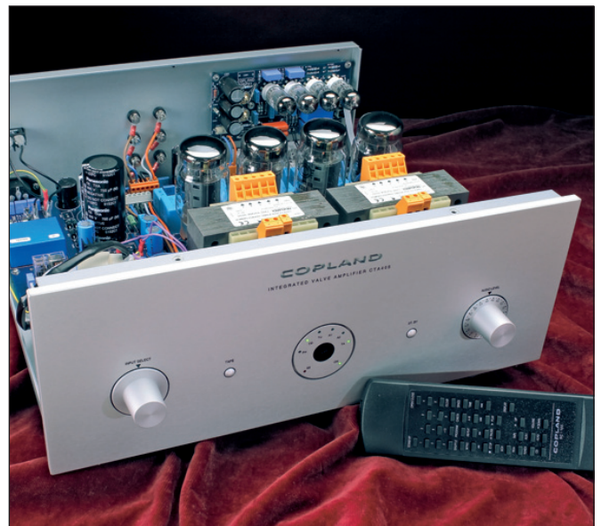
La costruzione del CTA-405 è di livello eccellente. I trasformatori di uscita sono costruiti su specifiche e tutte le valvole sono selezionate a coppie. A ridosso del pannello posteriore è assicurata la circuitazione dell'ingresso Phono per giradischi, realizzato con 4 valvole e caratterizzato da un basso rumore. Il telecomando è l'unica comodità concessa alla modernità.
