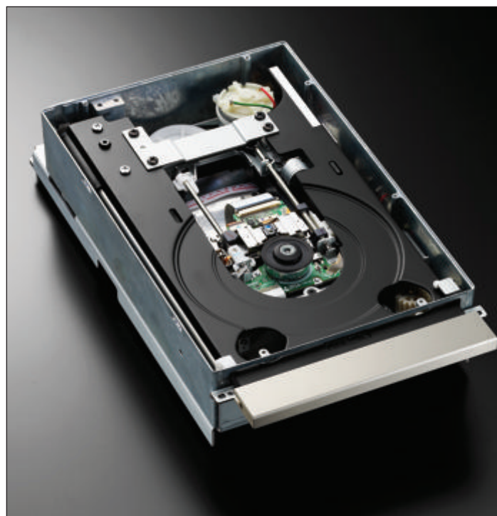
La magnifica meccanica di lettura "universale". Costruzione meccanicamente superlativa, grandemente affidabile, circondata da accorgimenti tecnici per proteggerla sia da shock esterni, sia da interferenze di vario tipo (magnetiche e radiofrequenze).
